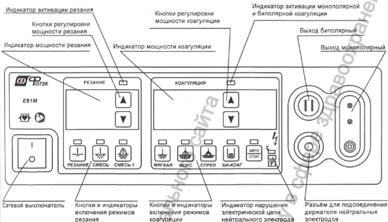
Рисунок 3 – Передняя панель ВЧ электрохирургического блока
